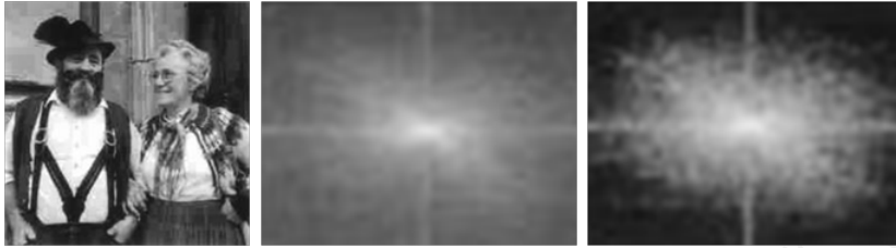
Abbildung 4.5: Einbettung eines Wasserzeichens im Frequenzraum, nach Cox u. a. (1997).
