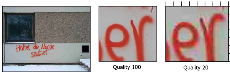
Abbildung 4.9: Illustration von JPEG-Kompressionsartefakten für libJPEGs Qualitätsstufen 100 und 20.
